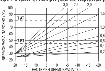
T AT μέγιστη θερμοκρασία setpoint θέρμανσης εγκαταστάσεων στάνταρ T BT μέγιστη θερμοκρασία setpoint θέρμανσης επιδαπέδιων εγκαταστάσεων
